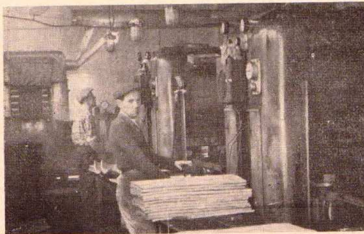
Niniejsze zdjęcie przedstawia wulkanizację płyt z gumy mikrokomórkowej i polanitu. Zatrudnieni przy tej czynności Józef Jaskowicz i Józef Tabak pracują w oddz. 313. Wymienieni normę dzienną wykonują przeciętnie w 165%; są wzorowymi pracownikami, cieszącymi się dobrą opinią załogi i kierownictwa tego oddziału.
